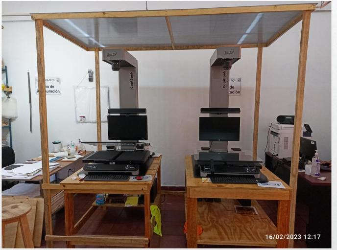
12:17 pm. Acabado final del tapanco construido por el personal de la Dirección de Servicios Generales para proteger a los escáneres del PIRAMB-CEFJS de la caída de fragmentos de plafón.
