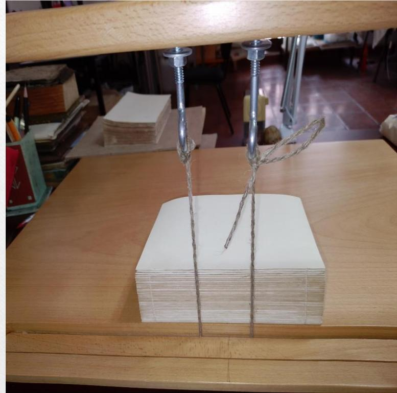
**1:39 pm.** Preparación del telar para el cosido de los cuadernillos con nervios de hilo flojo e hilo nylon.
