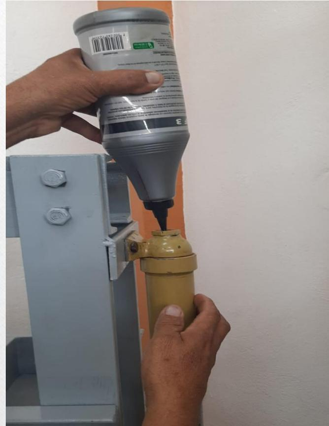
Mantenimiento de la prensa hidráulica del laboratorio de restauración.
