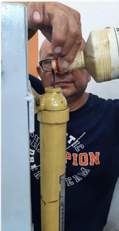
Engrasado y cambio de mangueras de la prensa hidráulica del laboratorio de restauración.
