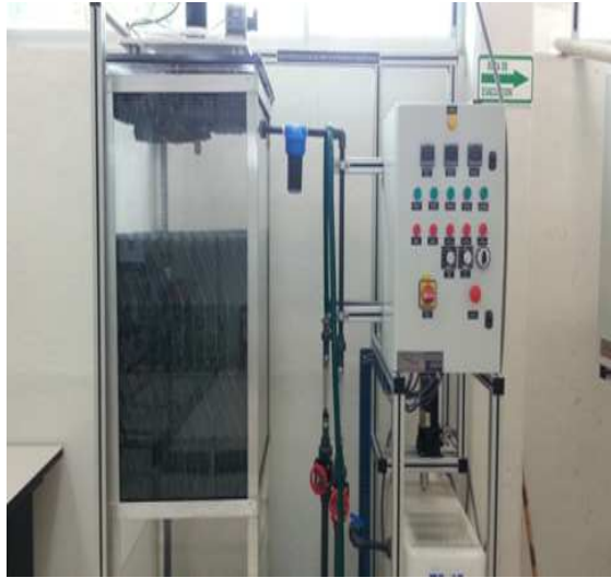
Figura 16. Equipo para estudio de una torre de enfriamiento
