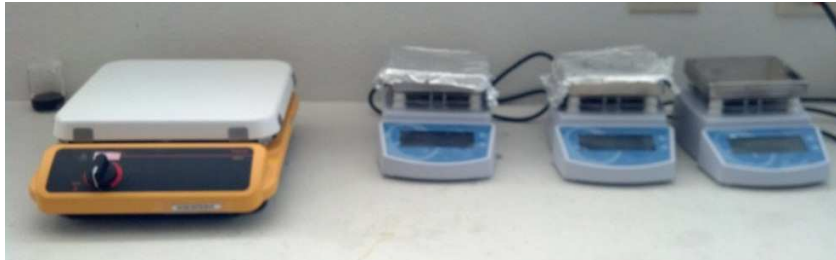
Figura 8. Parrillas de calentamiento
