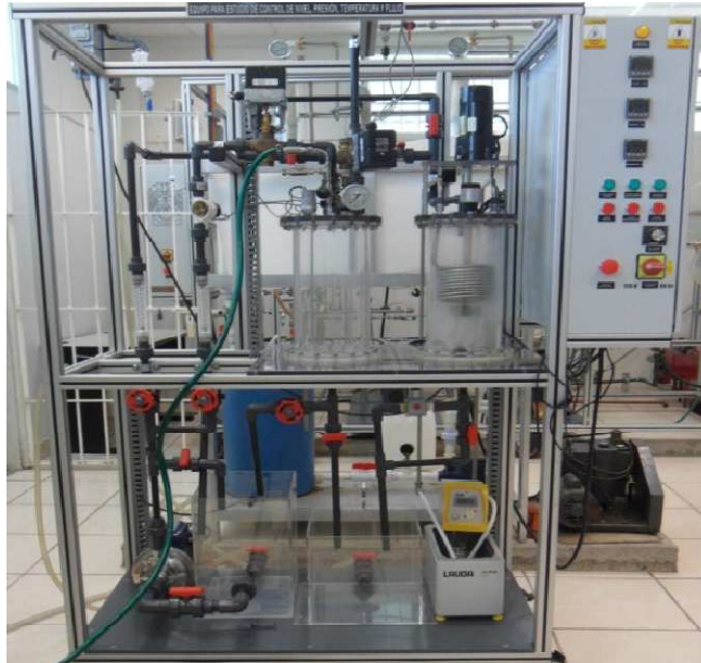
Figura 18. Equipo para estudio de control de presión, nivel, temperatura y flujo.
