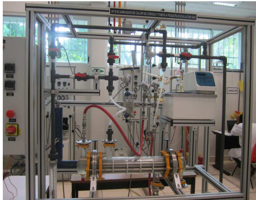
Figura 20. Equipo para el estudio de un intercambiador de calor de coraza y tubos.
